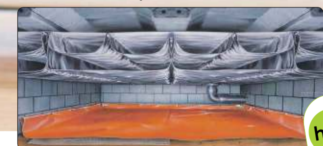
Illustratie van een kruipruimte met TONZON Vloerisolatie
